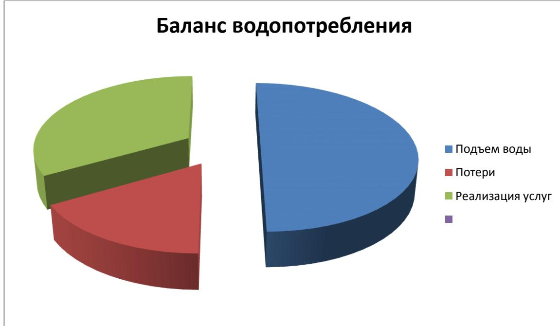
Для сокращения и устранения непроизводительных затрат и потерь воды ежемесячно производится анализ структуры, определяется величина потерь воды в системах водоснабжения, оцениваются объемы полезного водопотребления, и устанавливается плановая величина объективно неустранимых потерь воды. Важно отметить, что наибольшую сложность при выявлении аварийности представляет определение размера скрытых утечек воды из водопроводной сети. Их объемы
